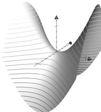
Le dessin montre le graphe de la fonction définie par  $f(x, y) = x^2 - y^2$ . On a représenté les lignes de niveau d'altitudes entières (0, 1, 2, ...).
