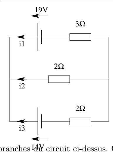
Calculer les courants dans les branches du circuit ci-dessus. On rappelle les lois de Kirchhoff : la somme (algébrique) des courants entrant en un noeud est nulle, et la somme des tensions (algébriques) le long d'une boucle du circuit est nulle. On a aussi la loi d'Ohm :  $U = Ri$  aux bornes d'une résistance :
